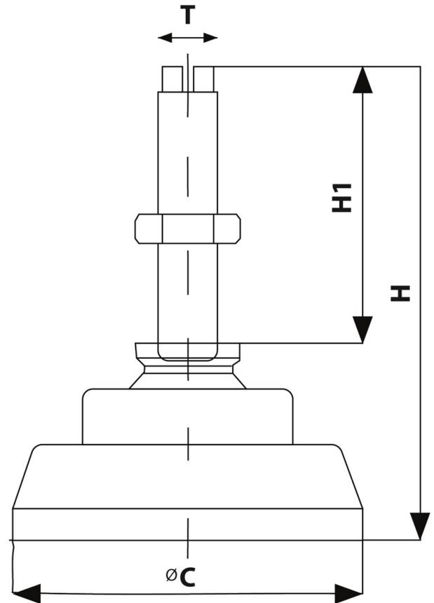
Patas niveladoras para celdas tipo viga (SHB). Fabricadas en aleación de acero y acero inoxidable con base de goma para mayor adherencia al suelo.
